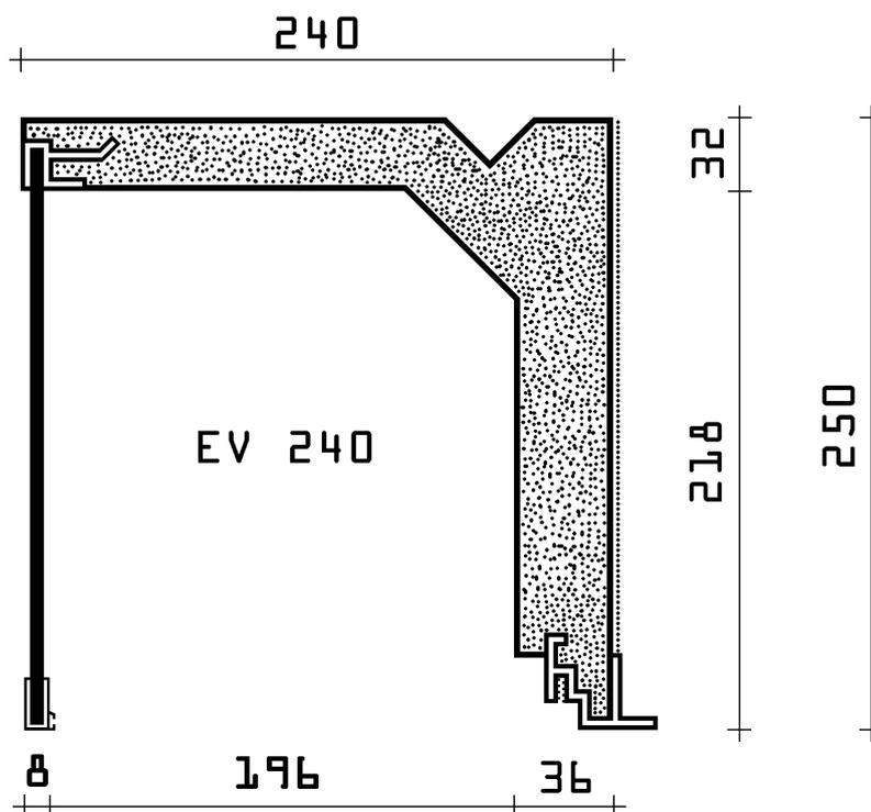
Serienmäßig haben alle Rolladenkästen der Typenreihe EV eine spezielle **Clip - Innenschiene** für den einfachen, schraublosen **EASY - CLIP - Deckelanschluss**, mit 15 mm Ausladung, sowie ein U-Profil als unterem Abschluss an der Außenschürze.
